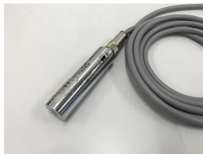
写真2 空振計 (7052NHS, ACO社製)
