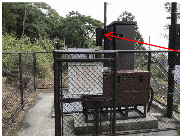
写真1 空振計 (火山近傍の常時観測点に他の観測装置と共に設置されている)
