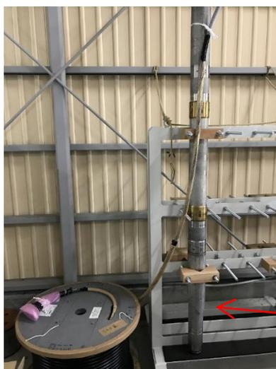
傾斜計は、地殻変動を測定する他の機器に比べ、時間分解能と感度が極めて高い特徴があります。0.1秒程度から数日程度の地盤の傾きの変化をリアルタイムで観測することができます。設置条件が良ければ、数ナノラジアン(1ナノラジアンは、1000キロメートル先が1ミリメートル上下することに相当する傾きの変化)の精度があります。時間分解能と感度が極めて高いため、噴火の前兆を捉えられる場合もあります。ただし、極めて感度が高いため、火山活動に伴う変化だけでなく、地球潮汐や降雨、井戸水のくみ上げ、地表の温度変化によっても変化します。また、傾斜計データには機器固有のドリフトや地震時のステップが含まれる場合があります。利用する場合には注意が必要です。
