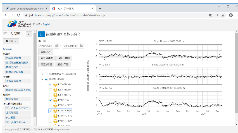
図6 V-net富士山観測点（N.FJSV, N.FJ6V, FY1V）の基線長変化データ。
